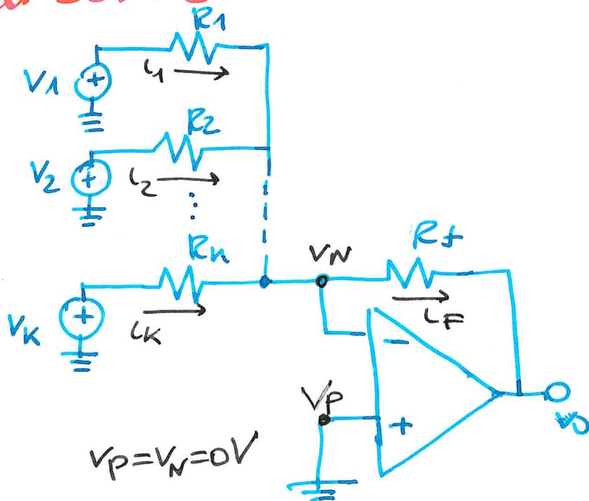
Tutte le correnti che attraversano le resistenze in serie ai generatori di tensione, confluiscono nelle resistenza di feedback  $R_F$ :
