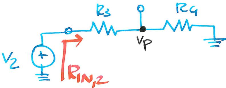
con  $R_{IN,2} = R_3 + R_4$
