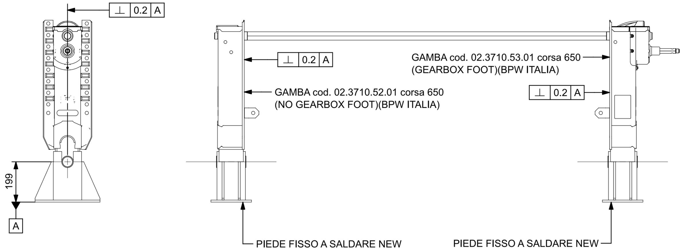
P.S.- SOSTITUIRE I PIEDINI ORIGINALI DEL SOLLEVATORE (mod.S)
