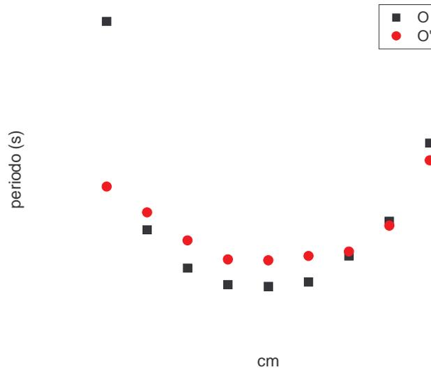
Si verifica che i periodi per i due perni si distribuiscono su due curve che si intersecano in due punti. Le due curve si intersecano ad una distanza di circa 20 cm e alle grandi distanze. Per le basse distanze l'angolo tra le due curve è maggiore che per le alte distanze e nell'intorno dell'intersezione i punti appartenenti alle due curve possono essere interpolati da due rette.
