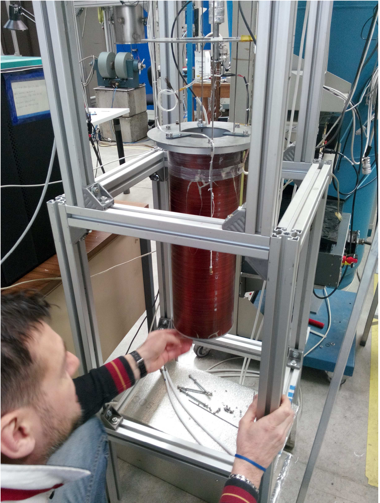
BOBINA SUPERCONDUTTRICE 2T CRYOGENIC IN FASE DI INSTALLAZIONE
