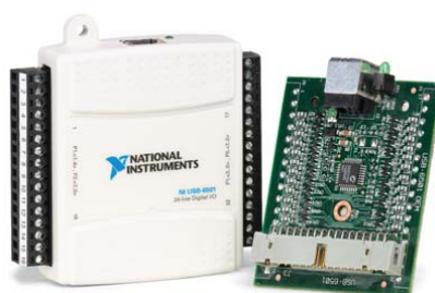
Figura 3.26: Scheda di input/output Labview USB-6501 utilizzata per la lettura degli angoli.
