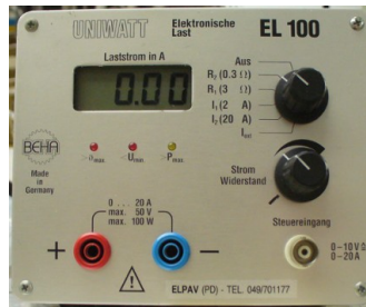
Figura 2.9: Foto del carico variabile utilizzato nel processo di misura di tensione e corrente. Modello Uniwatt EL100.
