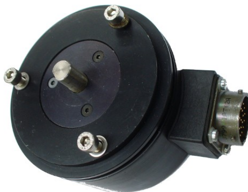
Figura 3.25: Foto di uno degli encoder utilizzati per la lettura degli angoli. Al centro il perno fissato all'asse di rotazione e a destra il connettore per la lettura del codice gray.
