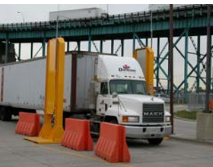
Fig.1 Esempio di portale per la rivelazione di materiale radioattivo attualmente utilizzato negli USA in uno dei punti di ingresso nel territorio nazionale
