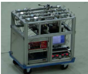
Fig.2 Un prototipo dell' attuale sistema ARKTIS basato sui nuovi rivelatori a gas nobili ad alta pressione.
