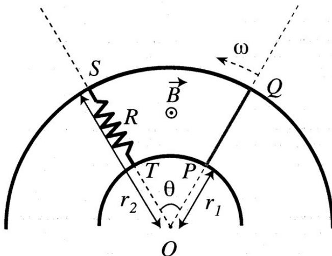
1) L'area di un settore circolare di ampiezza  $\theta$  è  $\Sigma_{\theta} = \frac{1}{2} r^2 \theta$ , per cui il flusso del campo magnetico attraverso il circuito  $PQST$  è
