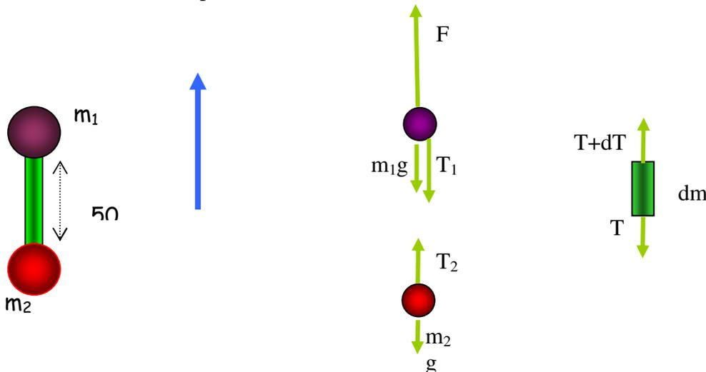
I due corpi e la sbarra sono collegati rigidamente per cui si muovono con la stessa accelerazione.
