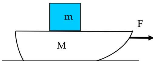
Su una slitta di massa  $M=35 \text{ kg}$ , scorrevole senza attrito apprezzabile su un piano orizzontale e inizialmente ferma, è posato un blocco di massa  $m=70 \text{ kg}$ . I coefficienti di attrito statico e dinamico tra blocco e slitta sono:  $\mu_s=0.40$  e  $\mu_d=0.33$ . a-Si calcoli il massimo valore della forza  $F$  che si può applicare alla slitta senza che il blocco scivoli rispetto alla slitta stessa.
