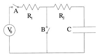
Ad un certo istante l'interruttore A viene chiuso e si attende che il condensatore sia completamente carico.
