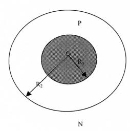
Un elettromagnete circolare di raggio R = 0.10 m produce un campo magnetico a simmetria assiale B = 0.55 \*(1-exp [-3\*t]) dove t è il tempo in secondi ed il campo è espresso in Tesla. Una spira circolare di raggio r = 0.25 m, costituita da un filo di sezione  $\sigma = 8*10^{-7} \text{ m}^2$  e di resistività  $\rho = 9.7*10^{-8} \Omega \text{m}$ , è posta in un piano perpendicolare alle linee di campo intorno all'elettromagnete. Calcolare:
