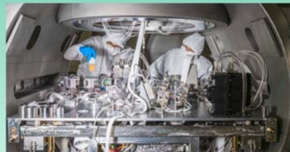
Tavolo di iniezione del laser di LIGO
