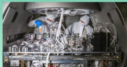
Tavolo di iniezione del laser di LIGO
