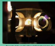
Specchi della cavità ottica dell'interferometro di Virgo montati sui loro prismi di supporto
