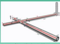
Schema dell'interferometro di Virgo
