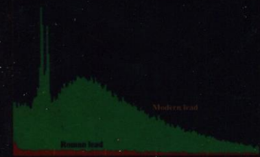
Spettro della radiazione gamma di un campione del piombo della nave romana a confronto con quello del piombo attuale. La radioattività del piombo romano, misurata da un gruppo di fisici di Milano, è praticamente nulla, confrontandosi con il fondo dell'apparato di misura.
