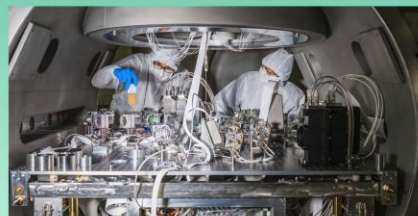
Tavolo di iniezione del laser di LIGO
