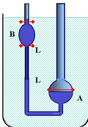
**Figura 1.** Rappresentazione schematica del viscosimetro di Ostwald.
