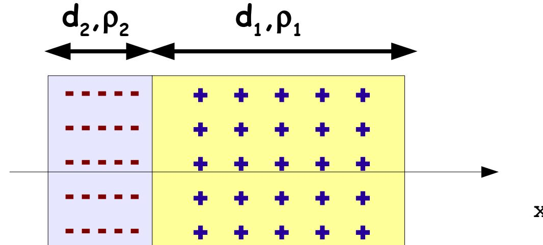
Il sistema in figura consiste di due regioni dello spazio in cui e' depositata uniformemente della carica elettrica con densita'  $\rho_1 = +0.1 \text{ C/m}^3$  ( $= 6 \cdot 10^{17} \text{ protoni /m}^3$ ) e  $\rho_2$ , rispettivamente. Le due zone hanno spessore  $d_1 = 50 \mu\text{m}$  e  $d_2 = 10 \mu\text{m}$  (le altre dimensioni sono molto maggiori). Calcolare:
