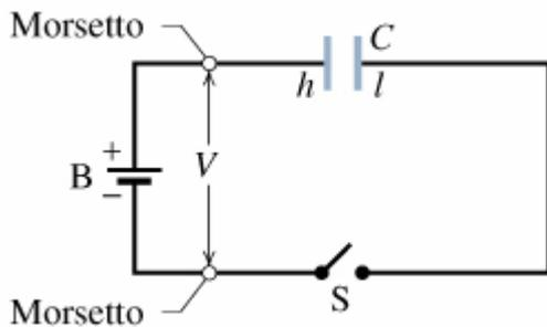
Il processo di carica di un condensatore consiste essenzialmente nel costruire un circuito che sia in grado di **portare la carica  $+q$  e  $-q$  sulle armature**. Il metodo più semplice è quello di collegare ciascuna armatura ai capi di una **batteria (B)** che fornisce una **d.d.p.  $\Delta V$** .
