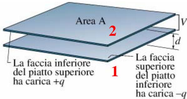
Consideriamo ora un condensatore le cui armature siano due **lastre conduttrici piane** e **parallele** di **area A** e a **distanza d** l'una dall'altra, la **carica** del condensatore sia **q** e lo spazio tra le armature sia inizialmente riempito d'**aria**.
