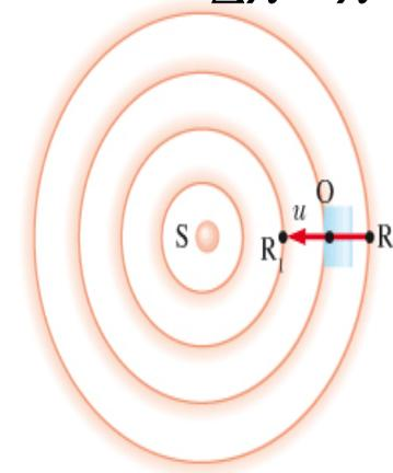
Quando invece è l'osservatore a muoversi con velocità  $v_1 < v_0$  verso una sorgente ferma che emette un'onda con velocità di propagazione  $v_0$ , si ha che la velocità di propagazione dell'onda viene percepita dall'osservatore come  $v'$  somma delle due velocità
