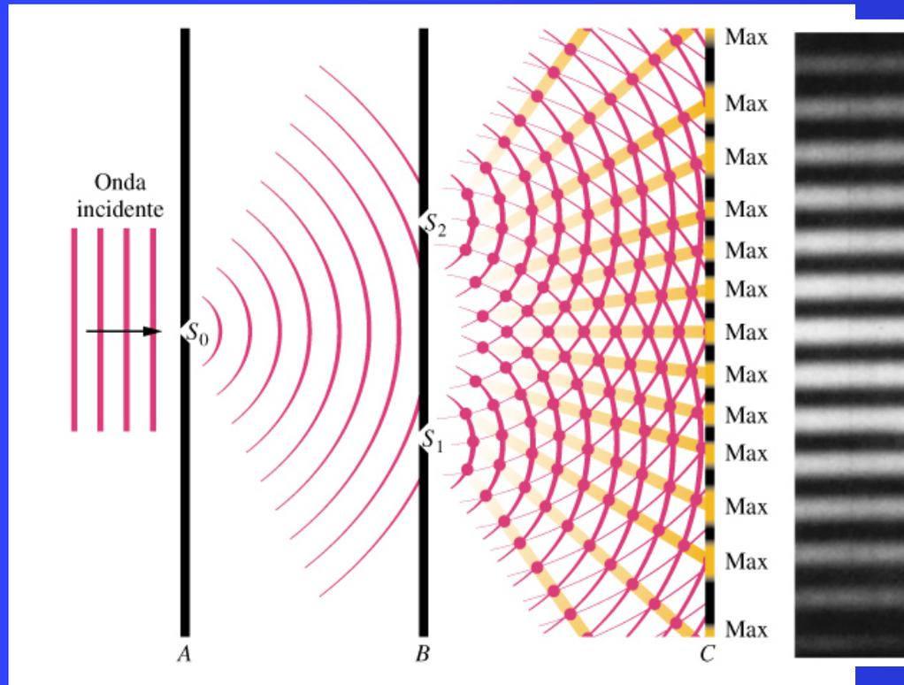
Inviando un'onda piana su uno schermo in cui è praticata una fenditura, per diffrazione l'onda emergente da  $S_0$  è un'onda sferica che va ad incidere su un secondo schermo in cui ci sono due fori,  $S_1$  ed  $S_2$ , che simulano due **sorgenti di luce coerenti** (in fase).
