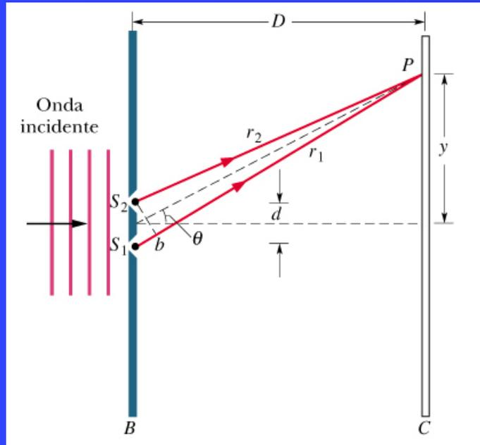
L'onda incidente arriva sullo schermo B in fase quindi **S<sub>1</sub> ed S<sub>2</sub> sono sorgenti coerenti di onde sferiche**. Se analizziamo l'immagine nel punto P, notiamo immediatamente che i **percorsi fatti dalle due onde**, quella da S<sub>1</sub> e quella da S<sub>2</sub>, **sono diversi**; pertanto **in P le due onde arriveranno sfasate per la differenza di cammino ottico ΔL**. Se **D >> d**, possiamo pensare che **r<sub>1</sub> ed r<sub>2</sub> siano praticamente ||**.
