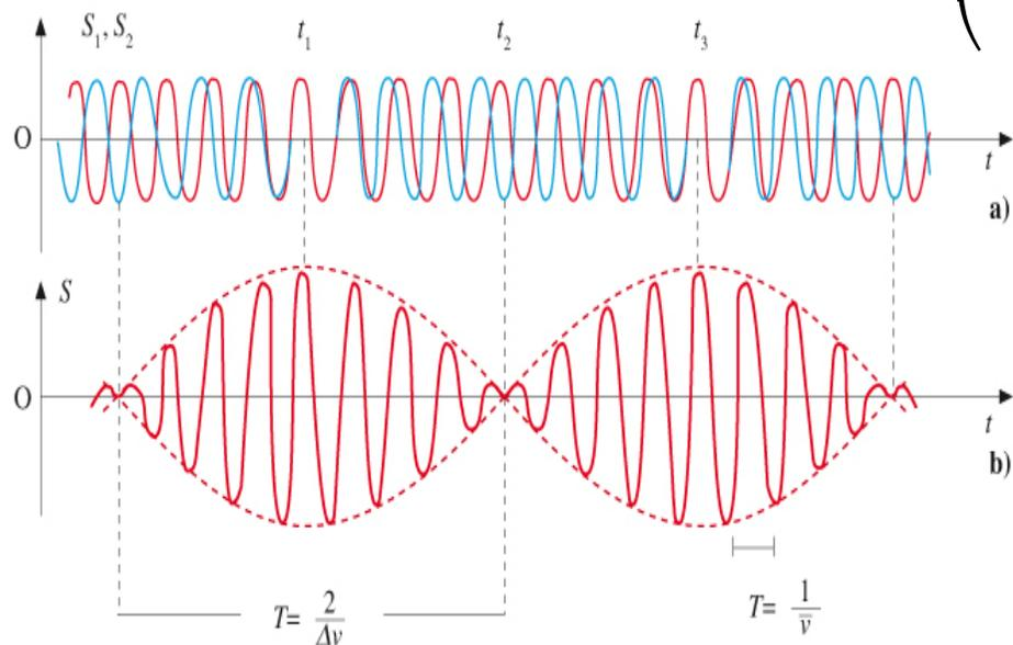
Si genera una vibrazione sinusoidale con frequenza pari alla media delle due frequenze originarie, l'ampiezza della vibrazione va come il coseno della differenza tra le frequenze.
