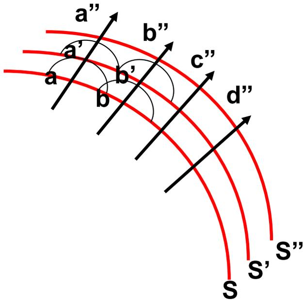
Le frecce sono  $\perp$  ai fronti d'onda e sono dette raggi: corrispondono alle linee di propagazione dell'onda (analogia con linee di forza e superfici equipotenziali)
