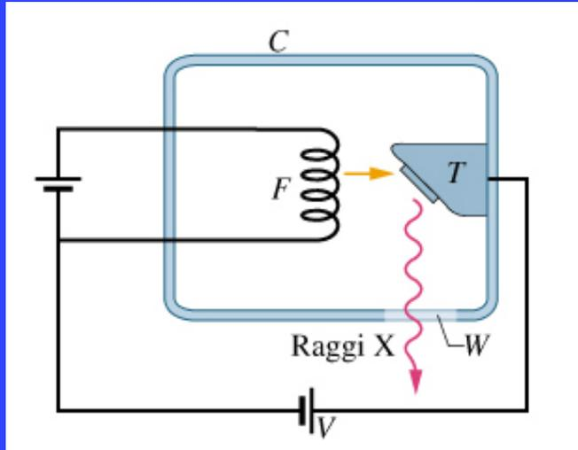
I raggi X sono onde elettromagnetiche con lunghezza d'onda dell'ordine di 0.1 nm. Se vogliamo distinguere tra raggi X con  $\lambda$  diverse non possiamo usare un reticolo di diffrazione, infatti ( $\lambda = 0.1$  nm e  $d = 3000$  nm) il massimo di ordine 1 si ha ad un angolo
