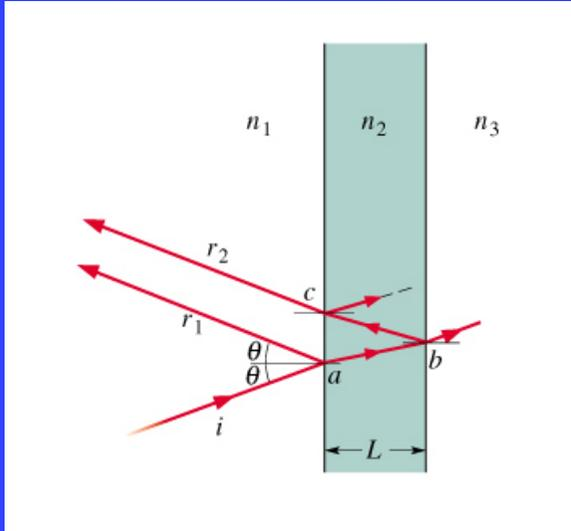
Facciamo incidere della luce su di una **lamina sottile di spessore  $L$  confrontabile con la  $\lambda$  della luce incidente**. L'angolo di incidenza  $\theta_i$  è **molto piccolo**. I due raggi  $r_1$  ed  $r_2$  seguono percorsi diversi e quindi **possono emergere sfasati dalla lamina**.
