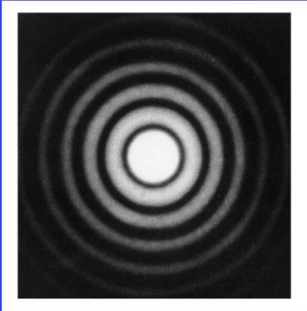
Prendiamo ora un foro circolare di diametro  $d$ , la figura di diffrazione che si ottiene è formata da cerchi luminosi e scuri alternati. Per la posizione del primo minimo si trova
