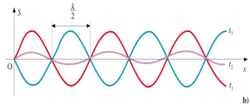
Su di una corda con entrambe le estremità fisse si può generare un'onda stazionaria, così pure in un tubo chiuso o aperto alle estremità, a patto che la lunghezza  $l$  della corda o del tubo permetta la formazione di nodi o due ventri alle sue estremità. Deve quindi essere soddisfatta la seguente condizione
