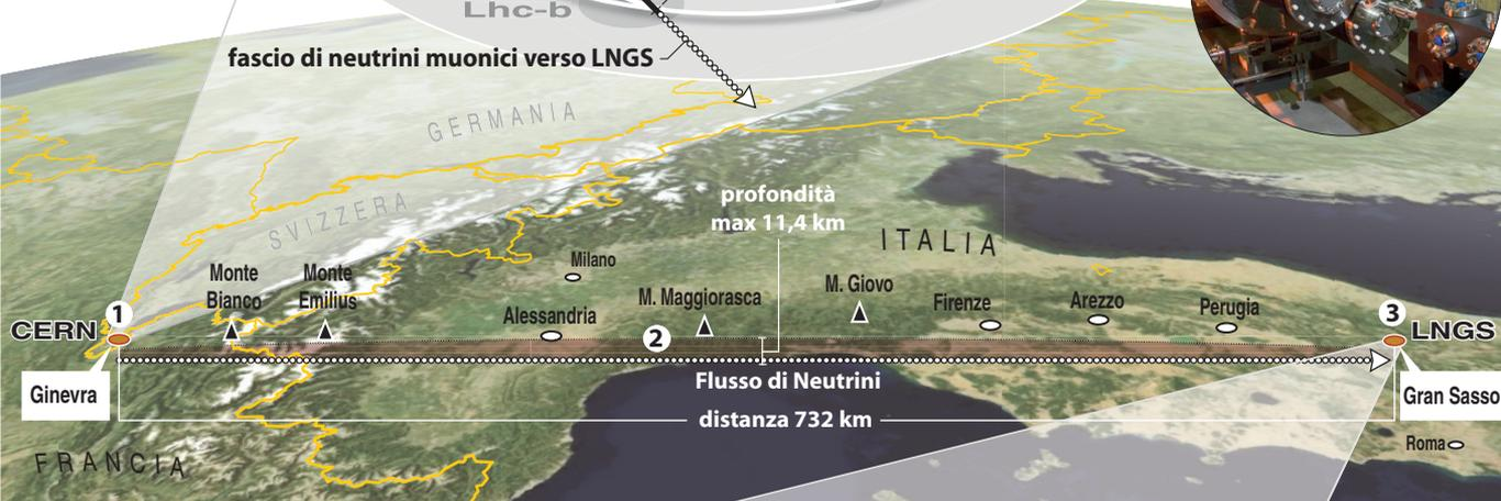
2 I neutrini attraversano la crosta terrestre per **732 km** e, viaggiando quasi alla **velocità della luce** giungono a destinazione dopo **2,4 millisecondi**
