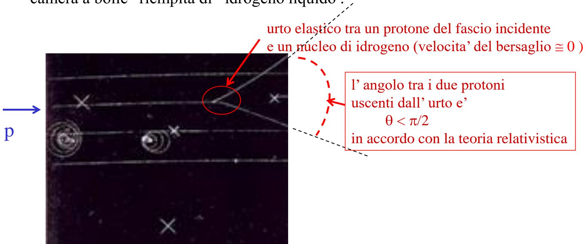
(nota: la visualizzazione delle tracce e' dovuta alla formazione di bollicine lungo il percorso delle particelle ionizzanti (i protoni), ottenuta grazie alla rapida espansione della camera, innescata attraverso un opportuno meccanismo di “trigger” al passaggio del fascio di protoni incidente )
