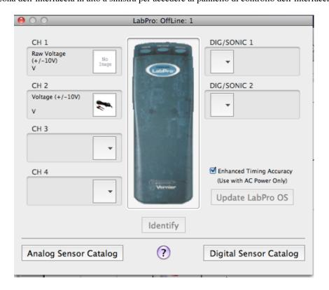
Sul pannello che compare, premendo sul canale connesso, scegliere *Choose Sensor* e seguendo il menu a tendina scegliere "*Raw Voltage*" con la sensibilità desiderata (4.9 mV se si sceglie  $\pm 10$ V e 1.2 mV se si sceglie  $\pm 5$ V).
